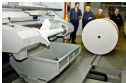
Der Rollenwechsel findet vollautomatisch bei auf Hochtouren laufender Druckmaschine statt
