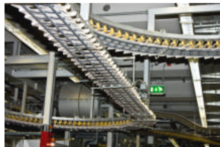
Die Ferag-Transportbänder liefern die einzelnen Ausgaben weiter zu den Einsteck- und Verpackungsmaschinen
